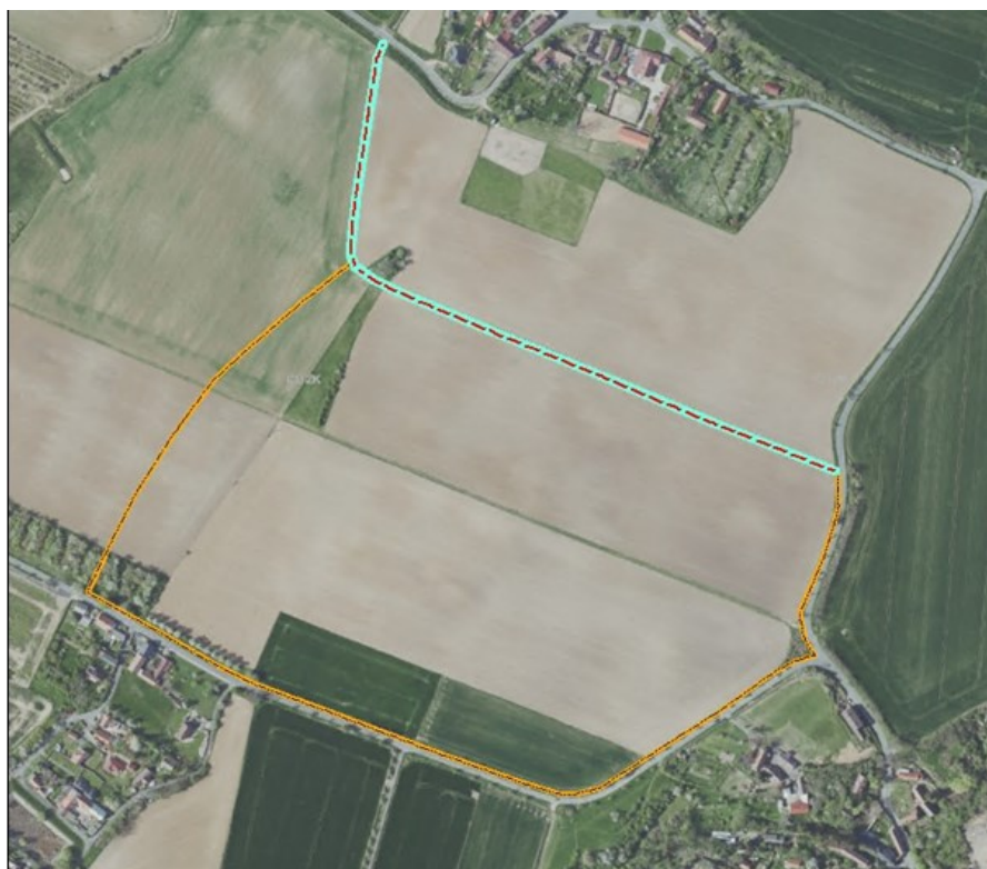
Obrázek 29: Uvažovaný odváděcí příkop nad zástavbou Dolan (červeně - čárkovaně) s vyznačenou sběrnou plochou (oranžová)
