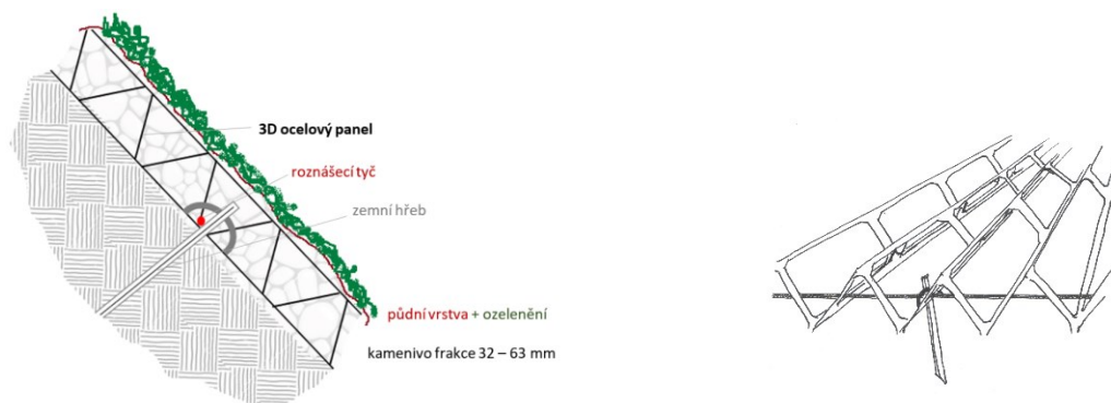
Obrázek 23: Příklad aplikace 3D ocelových panelů na svah – kresba: Jana Kalibová, Lucie Nebřenská
