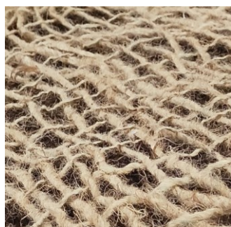
Obrázek 1: Svah krytý jutovou (vlevo) a kokosovou (vpravo) tkanou geotextilií – foto: Jana Kalibová
